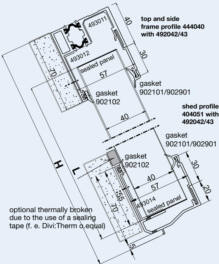
optional thermally broken due to the use of a sealing tape (f. e. Divi:Therm o. equal)
